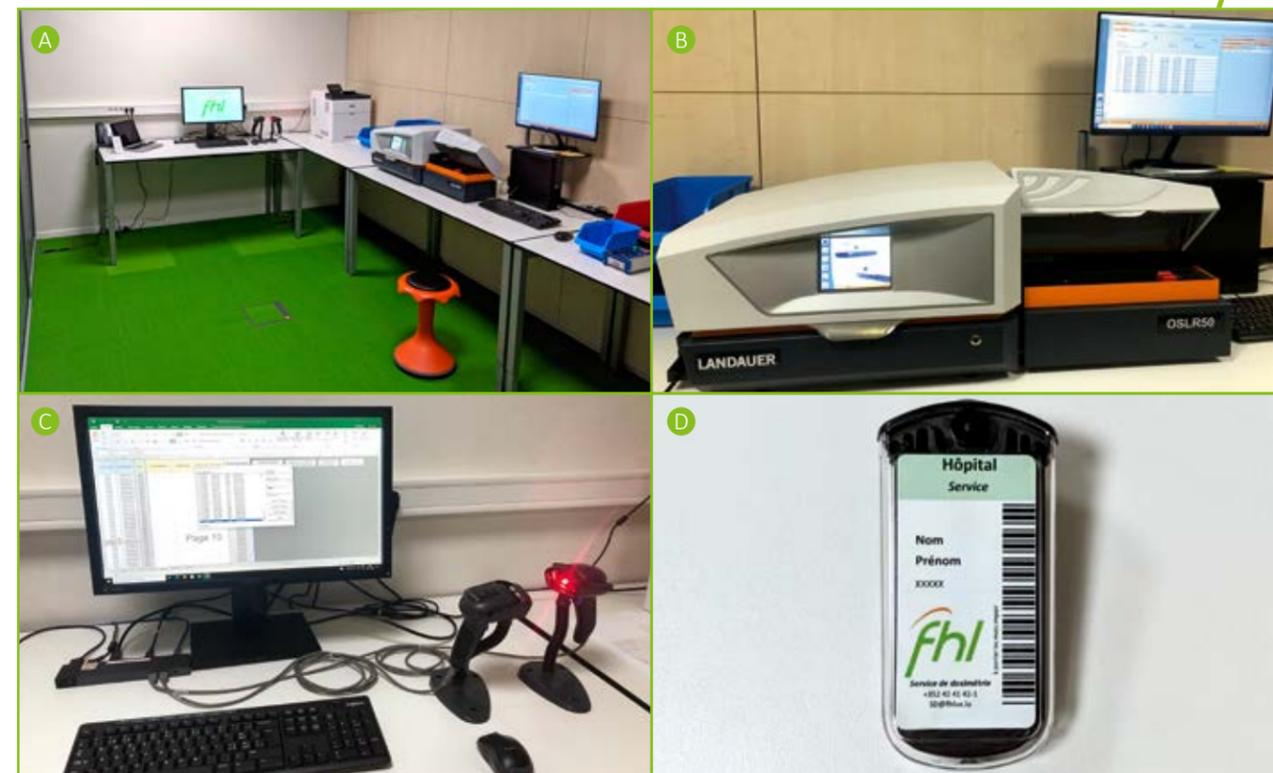
Figure 1: A: Service de dosimétrie de la CPM; B: Lecteur OSLR50 de Landauer; C: Base de données développée par la CPM; D: Dosimètre OSL.
