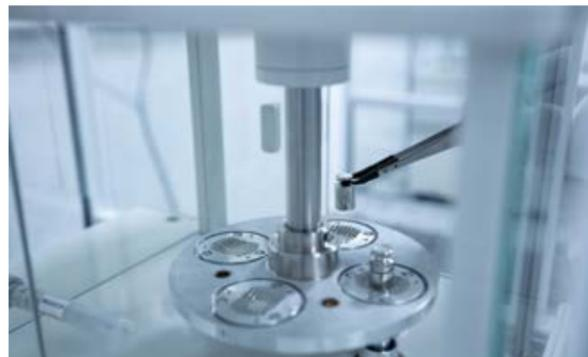
comparaison directe à un étalon E0 (étalons nationaux) ou à étalons de travail, couvrant une gamme de 1 mg à 20 kg, grâce à **cinq comparateurs de masses de la plus haute précision, dans des conditions ambiantes contrôlées et avec les meilleurs niveaux d'incertitudes.**
