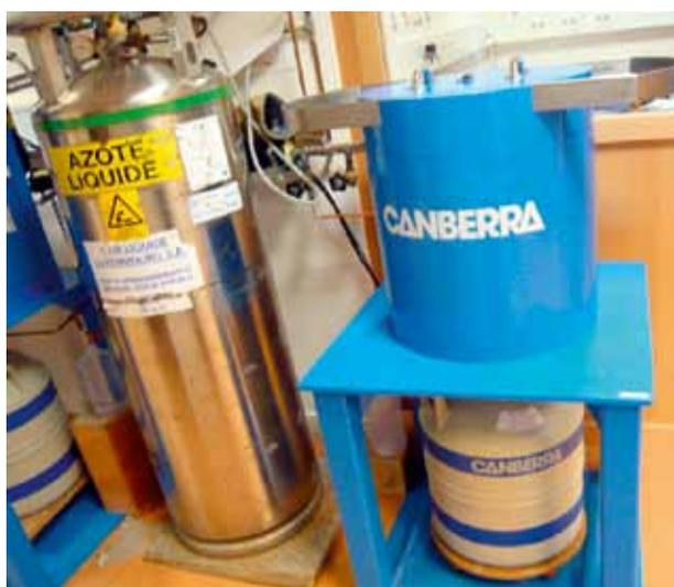
*Equipement de mesures en spectrométrie gamma. La partie supérieure du détecteur est située à l'intérieur d'un château de plomb en bleu. La partie inférieure est plongée dans un dewar rempli d'azote liquide*
